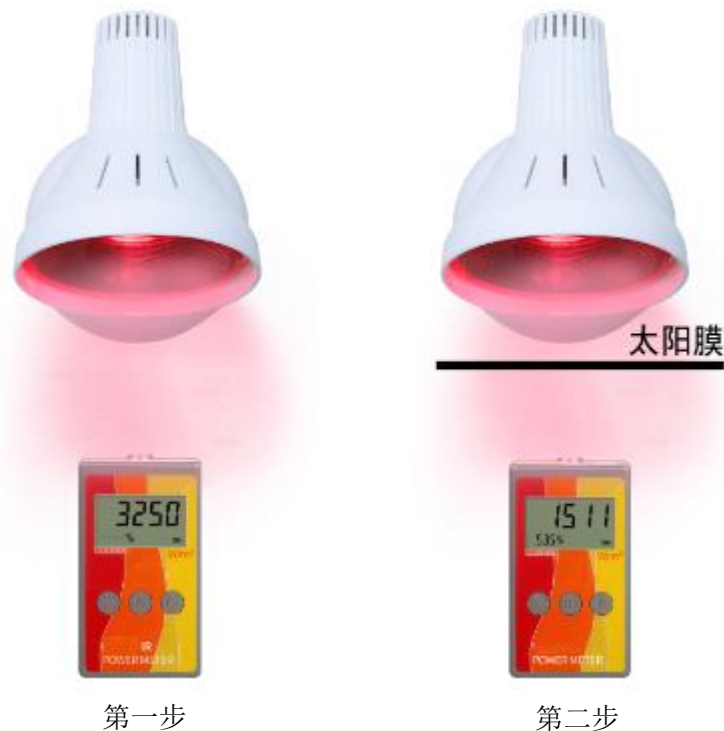
图 1 对太阳膜隔热性能的测量
