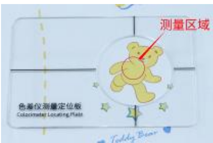
定位孔中心对准测量区域
